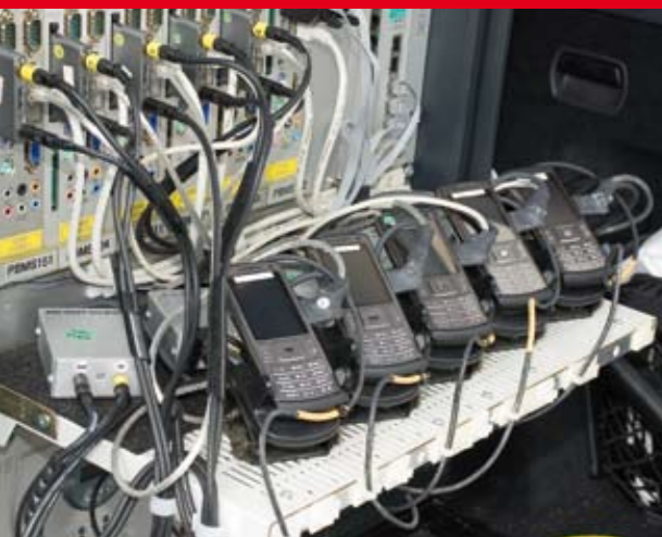
Fünf Blade-PCs im Hintergrund steuern die fünf Messhandys, bei 3 bis 4 Netzbetreibern besteht also Reserve.
